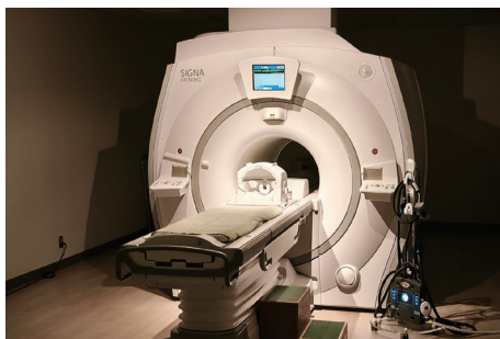
SIGNA Architect 3.0T MRI装置。脳の形態や活動に加え、白質線維の走行や代謝物濃度など多様な情報を高精度に可視化できる3テスラのMRI装置であり、本研究室における脳計測の中核を担っている。
