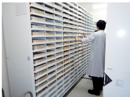
光学顕微鏡観察用ガラス標本を収納している電動式スタックランナー。 ガラス標本は200万枚保存しています。
